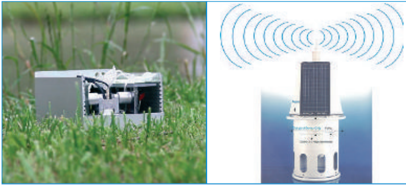
Abb. 4: Gewässerüberwachung mit Hilfe von biohybriden Sensorchips: In einem Gerät am Ufer eines Flusses (links) und in einer Boje für den Einsatz im See (rechts). ■
