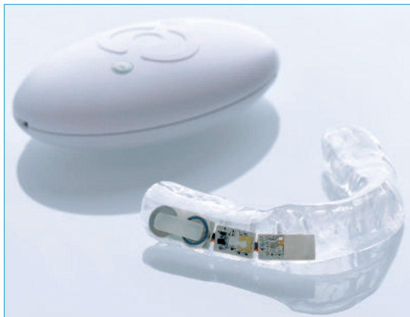
Abb. 7: Intelligente Zahnschiene SensoBite mit Sensor und Elektronik (unten) sowie Empfänger- und Vibrationseinheit (oben). [11] [12] ■
